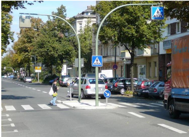
図 3-5 側帯のない交通島の例（ドイツ）<sup>5)</sup>
