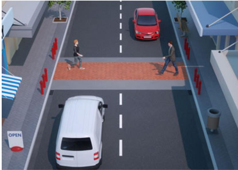
図 4-13 ダニーデン市における Courtesy crossing の設置イメージ<sup>2)</sup>
