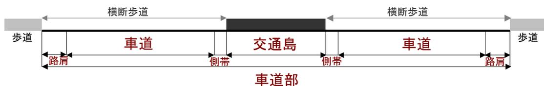
図 1-11 二段階横断施設の構成
