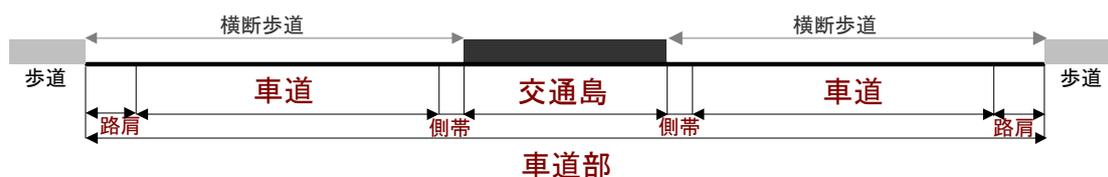
図 4-1 二段階横断施設の構成要素（図 1-11 再掲）
