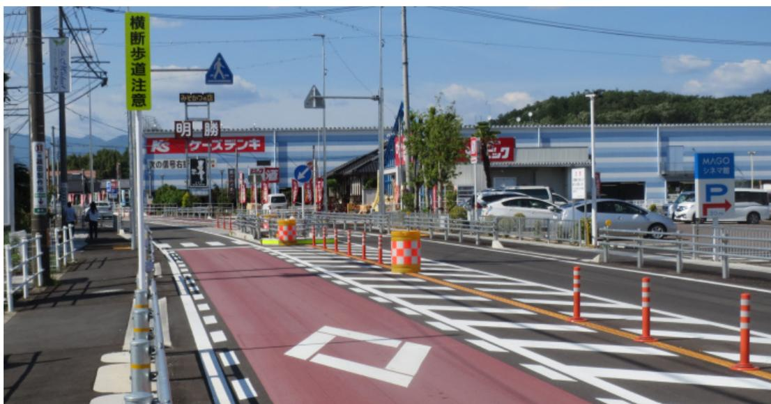
図 2-4 岐阜県関市での二段階横断施設導入後の様子
