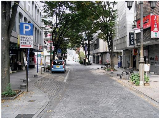
シケイン（スラローム型）の屈曲部に荷さばき車両の駐車ますを設けている。
