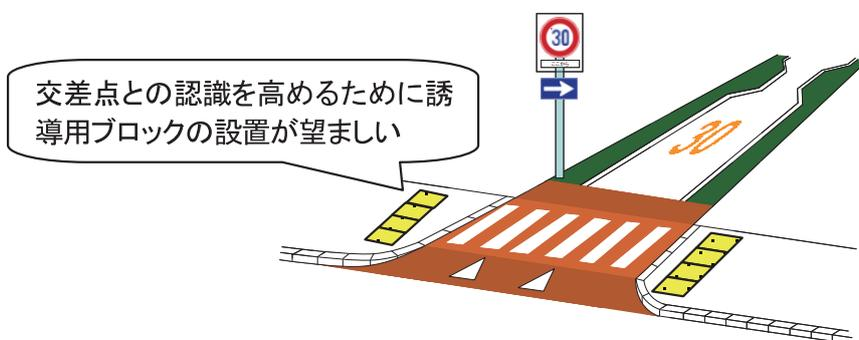
図 3.2.5.3 地区流入部の整備イメージ (スムーズ横断歩道・一方通行規制・最高速度地域規制・狭さく・路側帯のカラー化)
