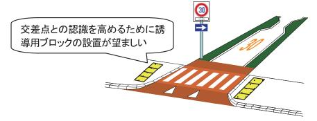
図 3.2.5.3 地区流入部の整備イメージ (スムース横断歩道・一方通行規制・ 最高速度地域規制・狭さく・路側帯のカラー化)
