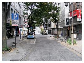
シケイン(スラローム型)の屈曲部に荷さばき車両の駐 駐車ますを左右交互に設置し、速度抑制効果をはかっ 車ますを設けている。
